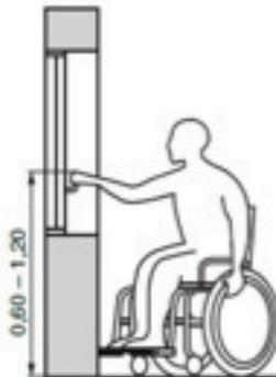
Figura 25 – Alcance da Janela – dimensões em metros
